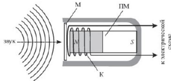
Рисунок. Электродинамический микрофон с подвижной катушкой
