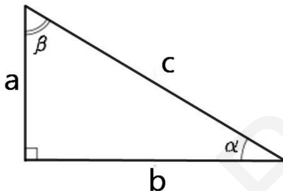
Катет  $a$ , лежащий напротив угла  $\alpha$ , называется **противолежащим** (по отношению к углу  $\alpha$ ). Другой катет  $b$ , который лежит на одной из сторон угла  $\alpha$ , называется **прилежащим**.
