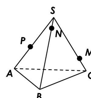
**№ 2. Построить сечение плоскостью, проходящей через три точки М, N и Р.**
