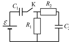
В начальном состоянии ключ К разомкнут, а конденсаторы не заряжены. Через некоторое время после замыкания ключа в системе установится равновесие. Какое количество теплоты выделится в цепи к моменту установления равновесия?
