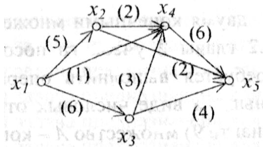
Это задача о максимальном потоке, которая заключается в поиске таких потоков по дугам, что результирующий поток, протекающий из источника  $x_1$  в сток  $x_5$  является максимальным. Задачу о максимальном потоке можно сформулировать как задачу линейного программирования и решить симплекс-методом. Но используем более эффективный **метод расстановки пометок** (метод Форда-Фалкерсона).
