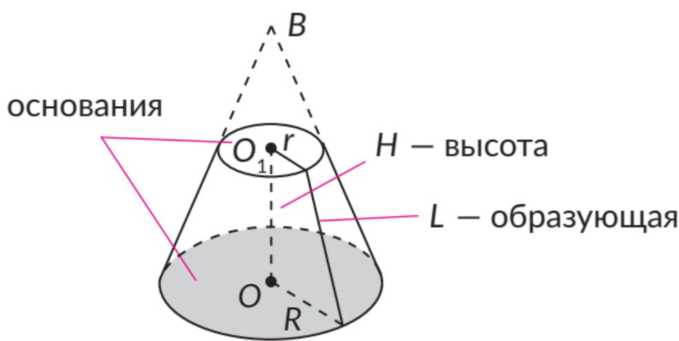
Часть конической поверхности, ограничивающая усечённый конус, – боковая поверхность.
