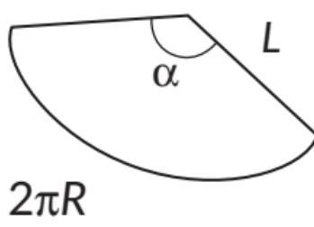
Боковая поверхность конуса (коническая поверхность) – сектор круга с радиусом  $L$ , длина которого  $2\pi R$  ( $R \neq L$ ).
